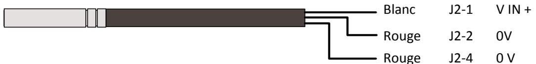
➤ Raccordement d'une sonde température numérique T ou Basse T°
