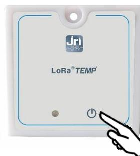
Pour éteindre le LoRa® TEMP', il faut appuyer sur le bouton poussoir entre 3 et 6 secondes.
