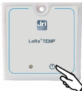
Le LoRa® TEMP' est activé par un appui long sur le bouton poussoir (plus de 3 secondes). Une fois activé, l'appareil mesure et transmet ses mesures au fil de l'eau à MySirius, à la fréquence définie dans MySirius.
